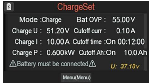
電池充/放電設置介面
