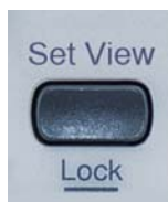
電壓/電流 預設值查看 & 面板鎖功能能防止人員誤操作導致待測體損壞的問題產生
