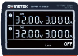
高亮度4.3寸LCD顯示幕並提供高解析功能10mV/1mA
